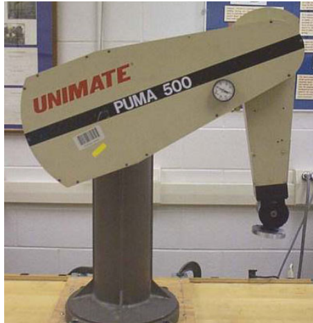
Slika 56. Robot serije PUMA500 od kojih se model 560 najčešće koristi u edukativne svrhe.
