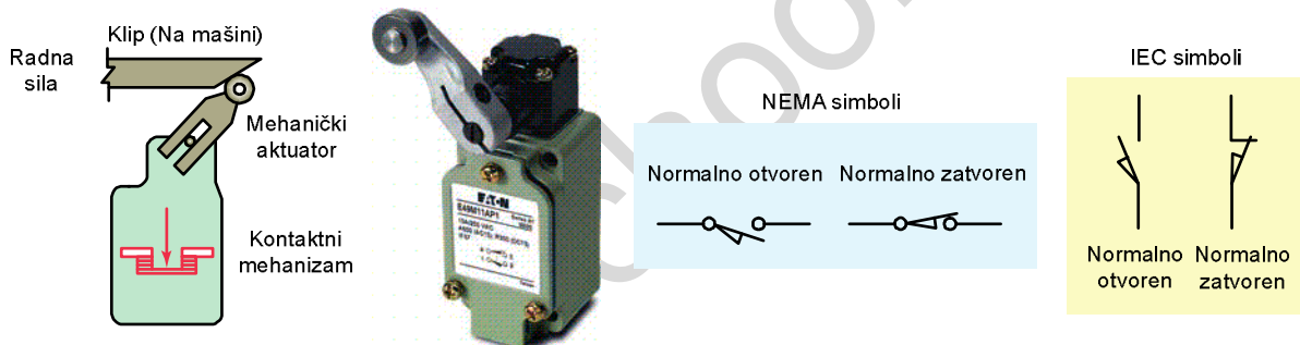
Slika 1.6 Izgled graničnog prekidača i simboli kontakata
