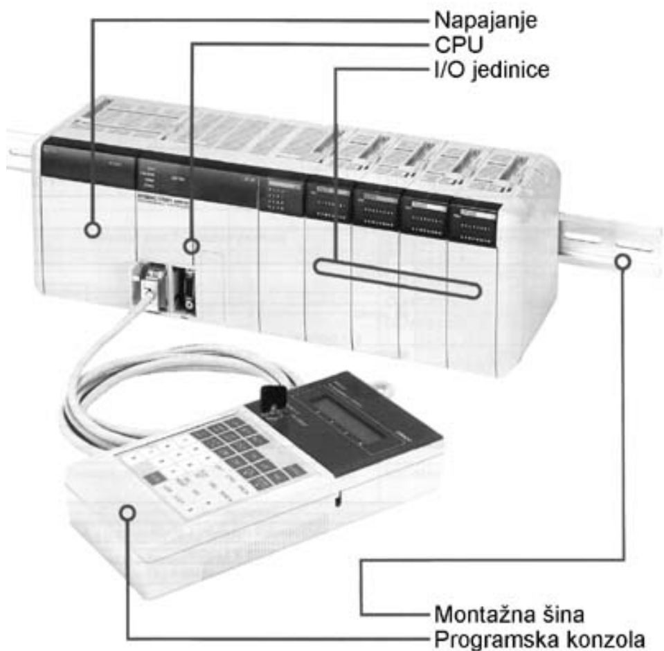
Spoljni izgled PLC kontrolera CQM1
