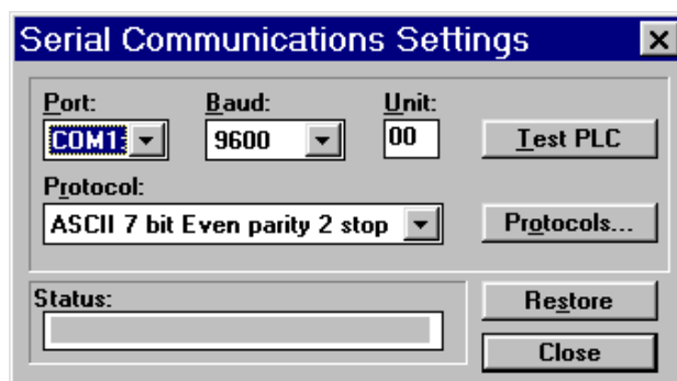
Podešavanje parametara komunikacije između PLC kontrolera i PC računara
