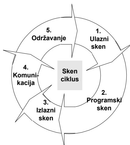
Sl. 2-1 Sken ciklus PLC kontrolera.
