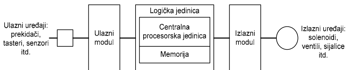
Sl. 1-1 Osnovni elementi programabilnog logičkog kontrolera.
