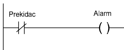
Sl. 2-4 Rang lider dijagrama sa normalno-zatvorenim prekidačem.
